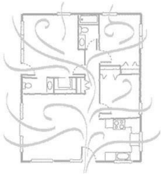
Khí vào qua cửa trước và ra qua các cửa phụ và cửa sổ.
